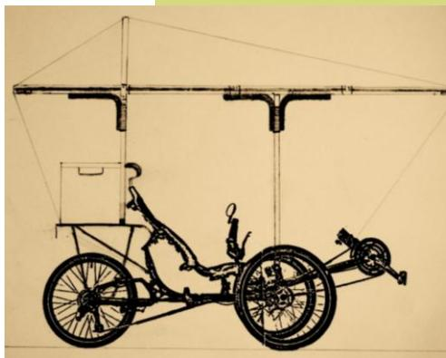
Pour un confort maximal, nous participerons au Sun Trip 2015 à bord de deux **trikes** – **tricycles** à deux roues avant – **couchés** à suspensions. Au-dessus de notre tête, une structure en alu, bois et cordage portera **quatre panneaux solaires**. D'une surface totale de 1,4 m<sup>2</sup>, ceux-ci chargeront **deux batteries** placées sous notre siège, qui à leur tour alimenteront un **moteur associé à notre pédalier**.
